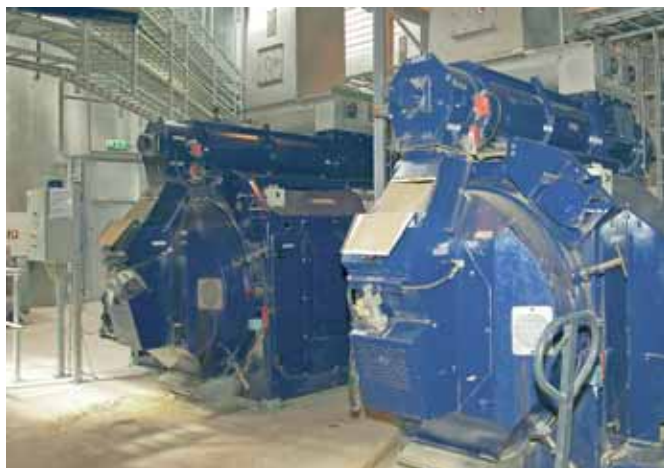
Projektet har gjort det lettere for fabrikanter at designe velfungerende pillepressere. Billedet viser to pillepressere på Køge Biopillefabrik.
