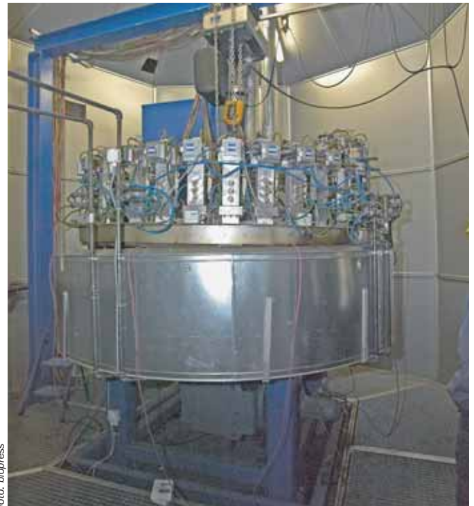
Den cylinderformede reaktor med de specielle elektronrør, magnetroner, der sender mikrobølger ned gennem halmen. Anlægget kan producere 40 – 50 liter olie i timen.
