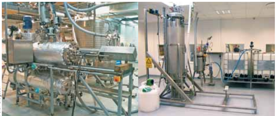
Biogasols pilotanlæg til henholdsvis forbehandling af biomasse (til venstre) og til fermentering af C5 sukker (til højre). Begge anlæg er placeret hos virksomheden i Ballerup, der i dag har 30 ansatte. Teknologien skal nu opskaleres til et pilotanlæg med en årlig produktion på fem millioner liter bioethanol, 3.000 MWh el og 7.000 tons biopiller.
