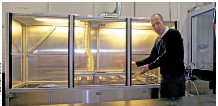
Teknisk direktør Thomas Steenberg demonstrerer, hvordan membraner til HT-PEM cellerne bliver støbt.
