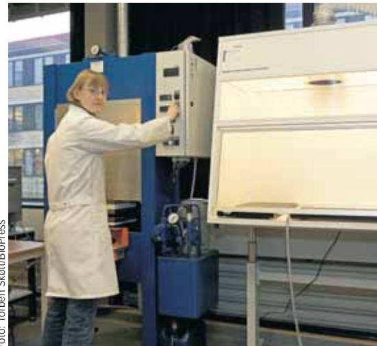
Produktionschef Carina Therkelsen har netop lagt en MEA ind i en varmpresser.
