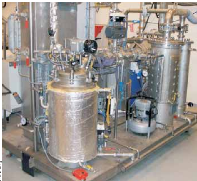
Xergi's forsøgsanlæg til trykkogning af biomasse.
