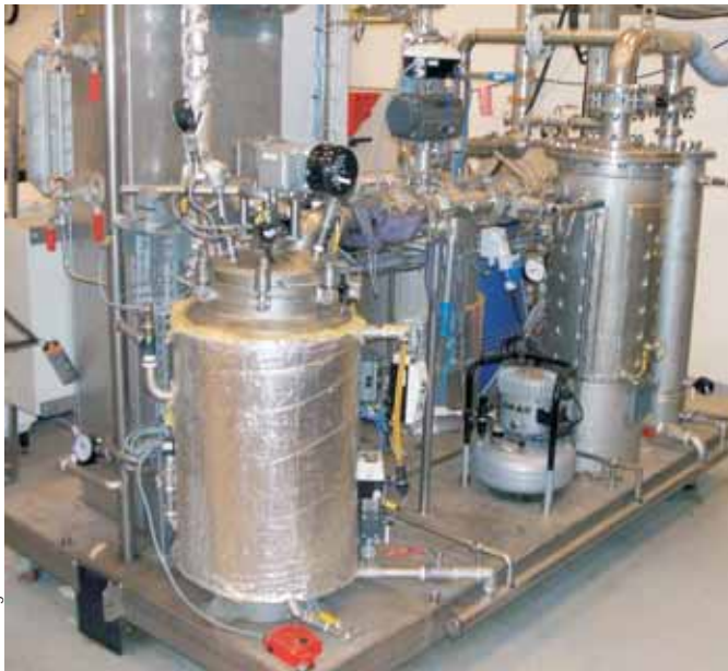
Xergi's forsøgsanlæg til trykkogning af biomasse.
