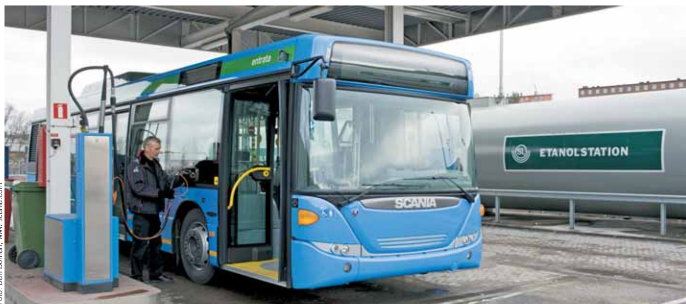
I Stockholm kører omkring 600 busser på bioethanol, heraf en del med dieselmotorer tilpasset ED95, der består af 95 procent ethanol og fem procent additiver.
