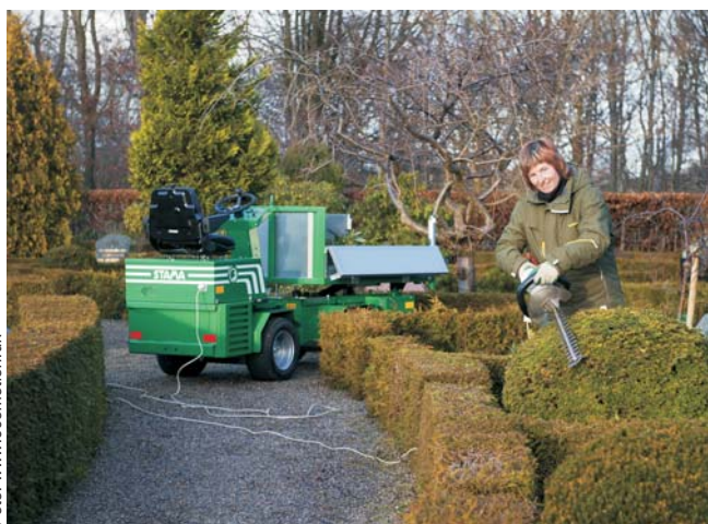
Eksempel på et nicheområde er trucks udstyret med brintdrevne brændselsceller til for eksempel kirkegårde, hvor gartnerne har mulighed for at tilslutte elværktøj.
