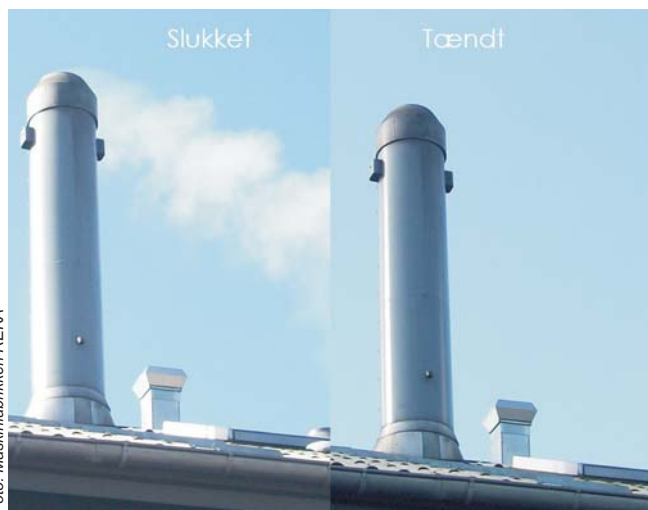
Test på AU-Foulum med biomassefyring, hvor elektrofilteret er henholdsvis slukket og tændt.
