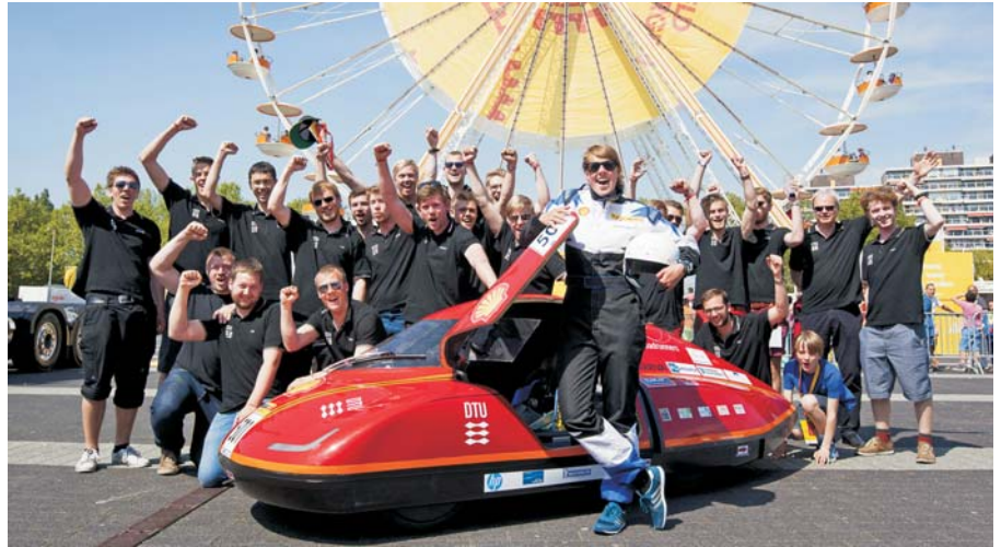
De studerende fra DTU vandt igen i år guld i deres ethanoldrevne bybil, men med "kun" 599 kilometer/liter opnåede de ikke at slå deres egen verdensrekord fra 2013 på 612 kilometer/liter.
