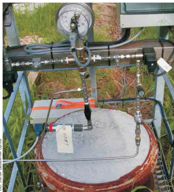
Dynamisk test af stål-rør i Fase II.
