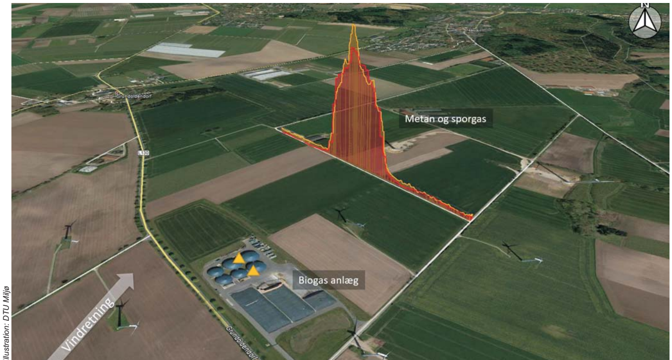
Figur 2. Eksempel på sporgasmåling til bestemmelse af metantab. Højden af den røde kurve er proportional med målte koncentrationer af metan over baggrundsniveau, mens højden af den gule kurve er proportional med koncentration af sporgas. De gule trekantede viser, hvor der blev frigivet sporgas.
