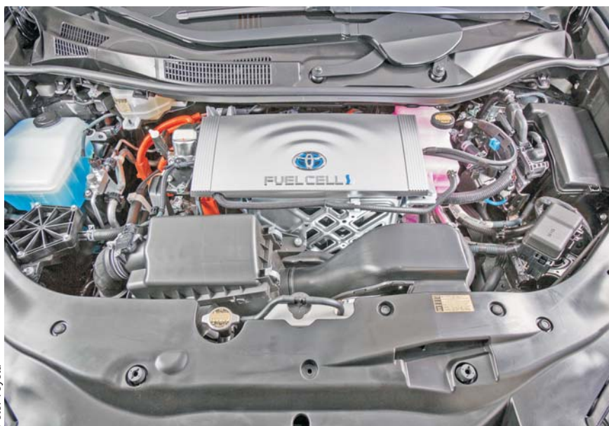
Et kik ned i motorrummet på Toyota Mirai, der er verdens første serieproducerede brintbil.
