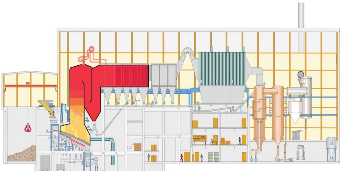
Linje 4 på Reno-Nord i Aalborg, der har været omdrejningspunkt i projektet. Anlægget behandler affald fra borgere og virksomheder i fem nordjyske kommuner.
