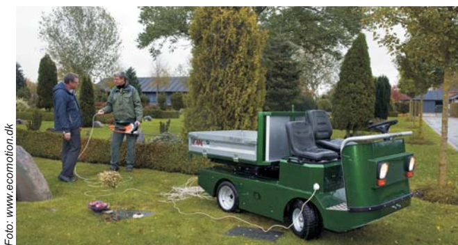
EcoMotion-trucken er udstyret med to strømudtag, som kan bruges til forskelligt elværktøj.
