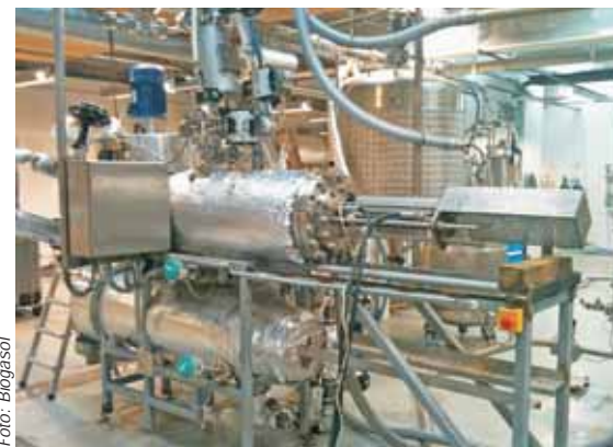
BioGasols pilotanlæg til forbehandling af biomasse.
